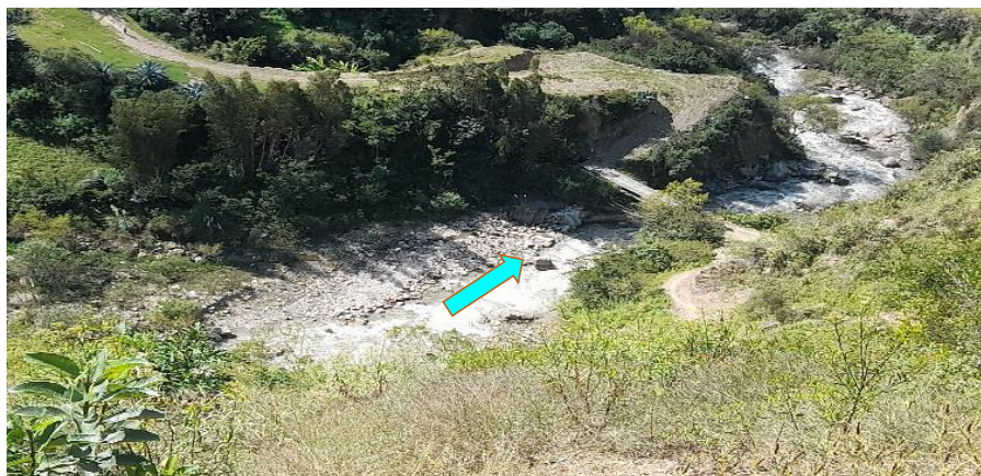
FIGURA N°01: TRAMO CRÍTICO EN EL RIO CERPAQUINO SECTOR LIMAGUAY SE APRECIA AGUAS ABAJO LA POSIBLE EROSION DEL CAMINO DE HERRADURA
